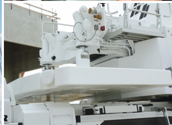
Automatic ballasting by pressing a button Lestage automatique par simple pression d'un bouton
