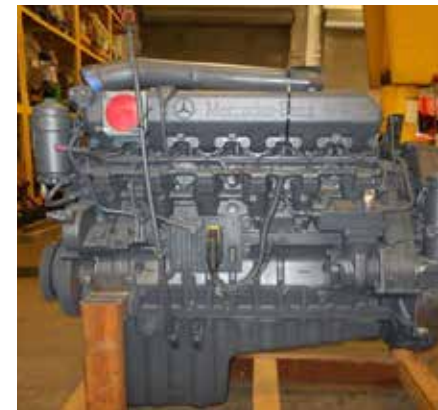
Mercedes Benz Engine OM460 LA SN 458.991-00-119876, 396 HP @ 1800 MA POR
